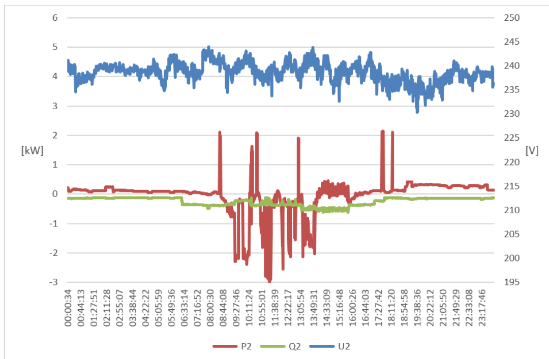
Rys. 12. Dobowa zmienność wartości pobieranej/generowanej mocy czynnej przez prosumenta W7 występująca w dniu 12.03.2020 (wartość dodatnia wskazuje na pobór mocy czynnej z sieci lub pobór mocy biernej indukcyjnej)
