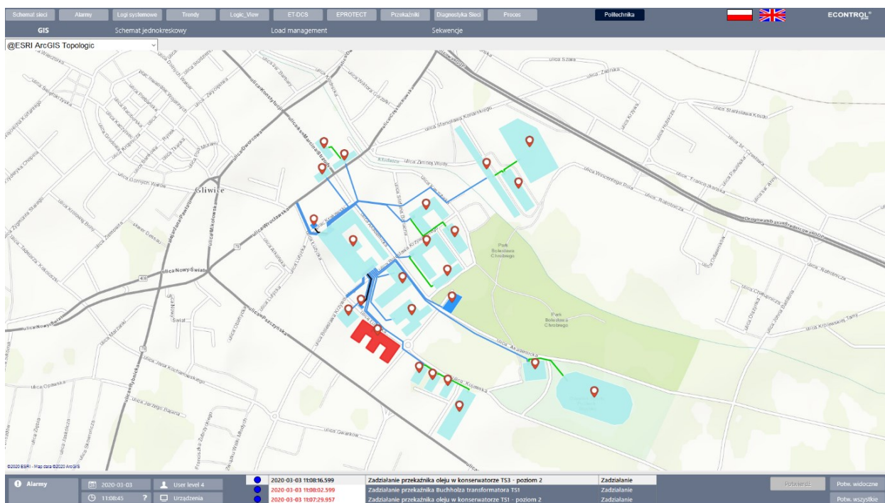
Rys. 6. Prosty, przykładowy układ zasilania kampusu uczelni – obiekty i linie naniesione na mapę cyfrową, linie kolorowane zgodnie z poziomem napięcia
