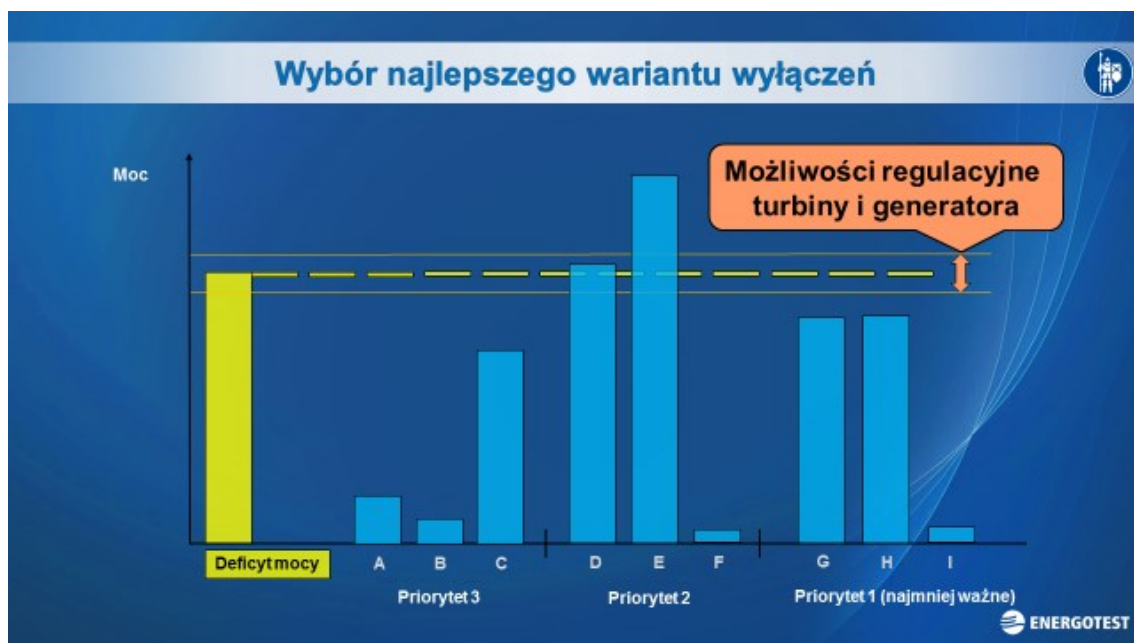
Rys. 3. Wybór najlepszego wariantu wyłączenia, uwzględniającego priorytetu technologiczne, w systemie SmartLoad realizowanym przez Energotest
